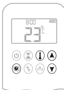
**NOTA:** la temperatura impostata per la modalità Termostatica è quella impostata per il tempo di attivazione in modalità Programma. La modifica della temperatura impostata in modalità Termostatica comporta anche il cambiamento della temperatura del periodo di attivazione in modalità Programma.
